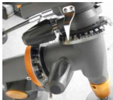
obr. 4-7 kruh deklinace - nahoře, rektascenze - dole
